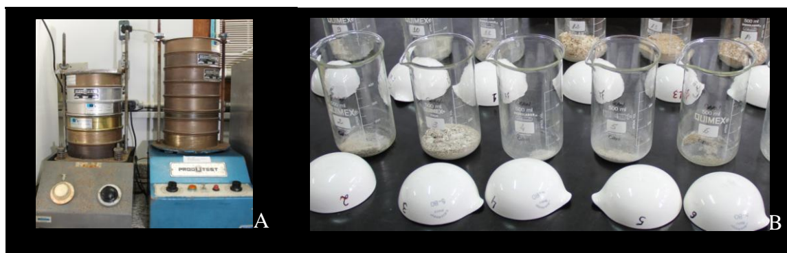
Figura 7: Fração grossa do sedimento. (A) Agitador com peneiras granulométricas para separação da fração grossa do sedimento; (B) Fração grossa separada e pronta para pesagem.
