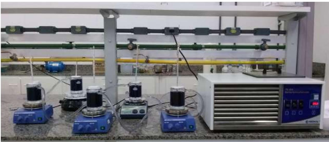
Figura 13. Teste de sorção com controle de temperatura.
