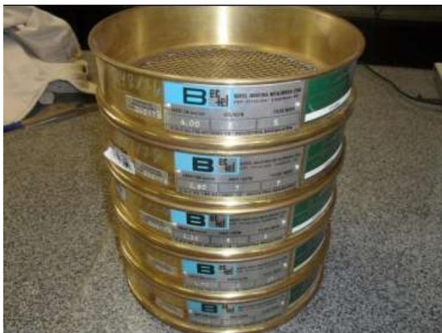
Figura 12. Conjunto de peneiras para ensaio granulométrico.
