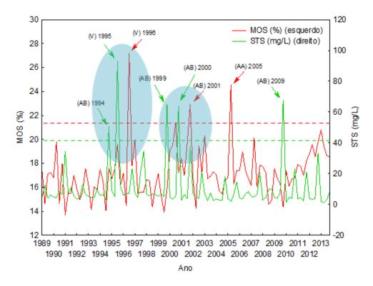
Figura 25: Séries de MOS (vermelho) e STS (verde) na estação REF1, ao longo dos 25 anos monitorados. As linhas pontilhadas demarcam o critério de definição dos valores extremos (acima da média + 2DP da série). O limites foram de 21,56 % para MOS e 41,67 mg/L para STS. Na área azul estão situações onde picos de STS antecedem picos de MOS.
