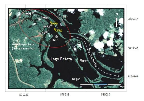
Figura 10: Localização das estações de coleta no Lago Batata. Pontos brancos referentes às estações amostradas no monitoramento do ambiente aquático. Área impactada circulada em vermelho. Estações próximas a bancos de arroz (pontos amarelos) foram acrescentados somente no estudo de testemunhos do sedimento (presente estudo). Coordenadas em UTM - 21M. Fonte: Google Earth - imagem de Jan/2008 (acessado em Jan/2014).
