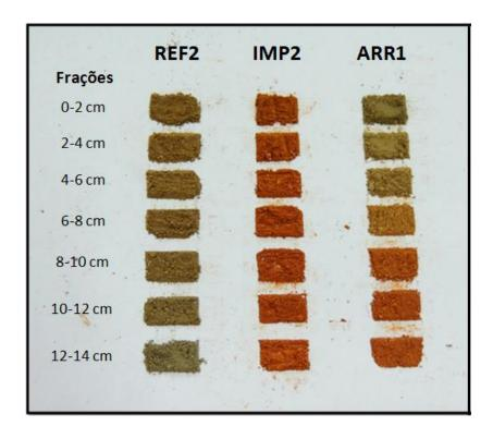
Figura 16. Coloração das frações que compõem os testemunhos do sedimento coletados em março de 2014. A coloração avermelhada é associada ao rejeito de bauxita enquanto a coloração marrom esta associada a concentração de matéria orgânica.
