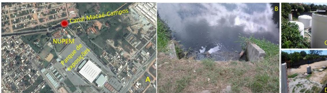
**Figura 5 – (A) Local de coleta da amostra de efluentes que desembocam no Canal Macaé-Campos (círculo vermelho). (B) As amostras são coletadas antes de se diluírem na saída da manilha que conduz o efluente até o canal. (C-D) Em frente ao ponto de coleta existe um terreno com reservatórios de efluentes trazidos por caminhões coletores. Esses efluentes desembocam no canal sem tratamento prévio.**
