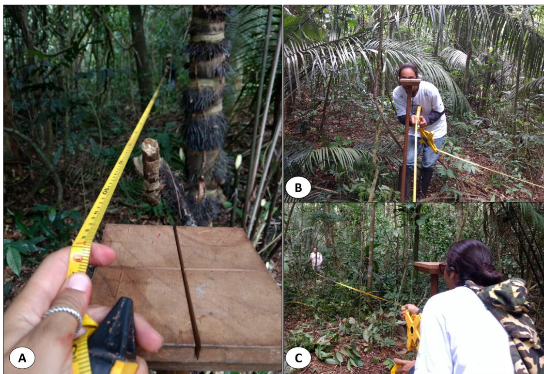
Figura 2: Instalação das unidades amostrais: a: Cruzeta instalada no Ponto Central (PC). b-c: Balizamento a partir da ranhura da cruzeta para demarcação dos Pontos Finais (PF) alinhados totalizando 50 metros.
