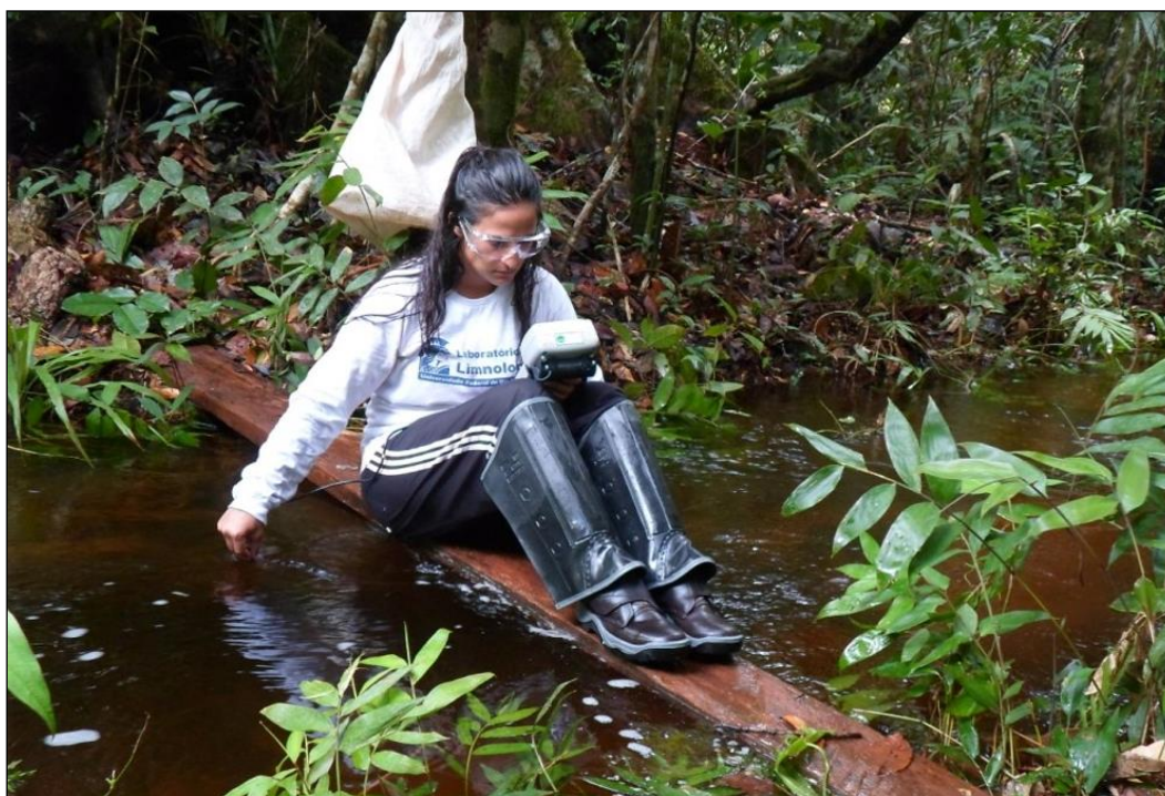
Foto 8 - Amostragem de algumas variáveis abióticas dos riachos (temperatura, oxigênio dissolvido na água). Foto de arquivo pessoal.
