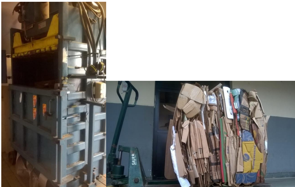
Imagem 12 e 13: Prensa utilizada para prensar papel e papelão. Papelão prensado e amarrado indo para sua caçamba aguardar o recolhimento. Fotografia por Danielly Pierre.
