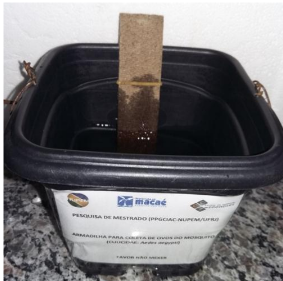
Figura 16. Armadilha para captura de ovos de mosquitos (ovitrampa). Estes tipos de armadilhas são capazes de fornecerem dados úteis sobre a distribuição espacial e sazonal dos mosquitos numa determinada região.
